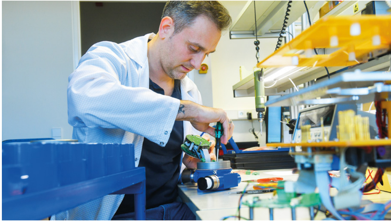
Ein Mitarbeiter in der Fertigung von ACI bei der Endmontage von Photoionisationsdetektoren
