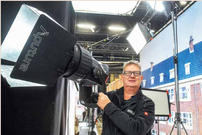
Lichtexperte Mike Zimmermann an einer 1 200-Watt-Bouncelampe, die über den sogenannten Bouncer warmes Tageslicht nach unten schickt
