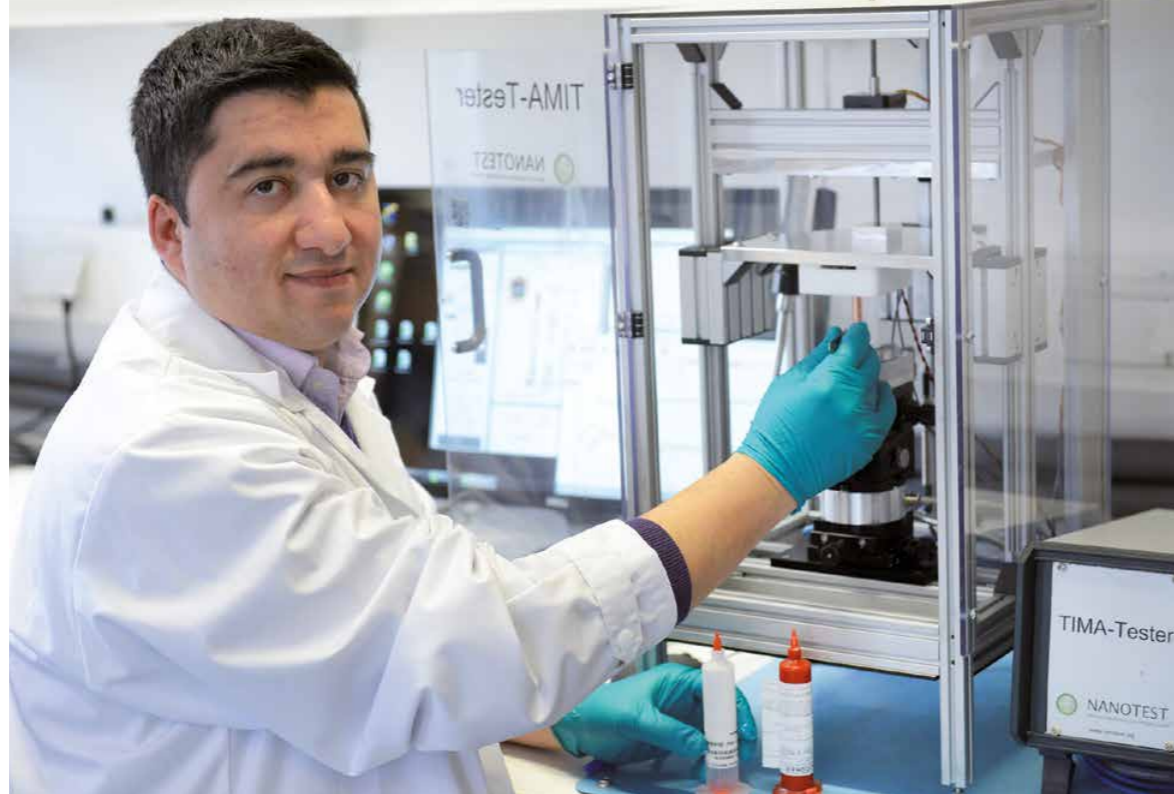
Mohamad Abo Ras: Am Prüfstand zur Charakterisierung von thermischen Interface-Materialien
