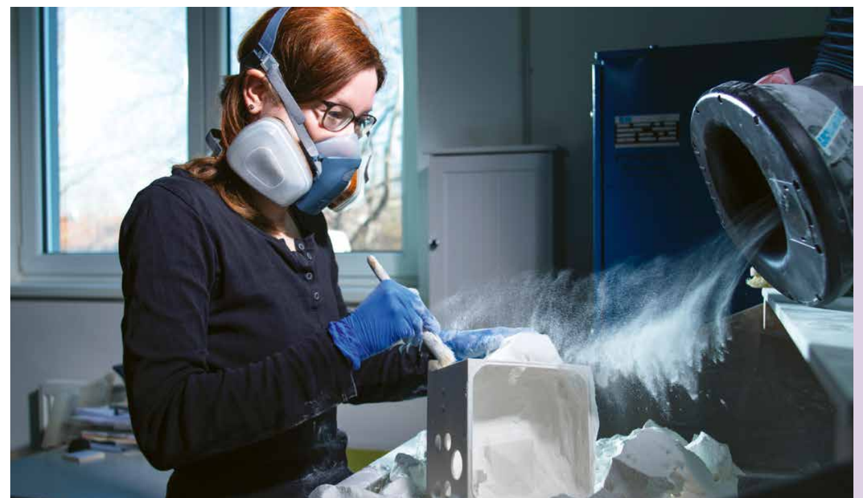
Eine FASTPART-Mitarbeiterin entformt ein 3D-gedrucktes Lasersinterenteil aus Polyamid
